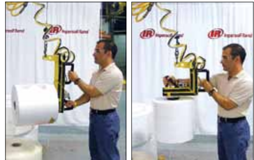
Mühelose Drehung von horizontal zu vertikal
